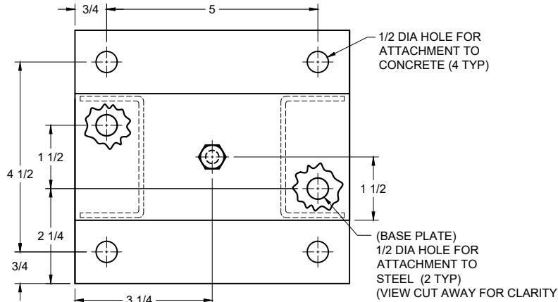
MODEL MSS-1C SEISMICALLY RESTRAINED VIBRATION ISOLATOR FOR 1" DEFLECTION
